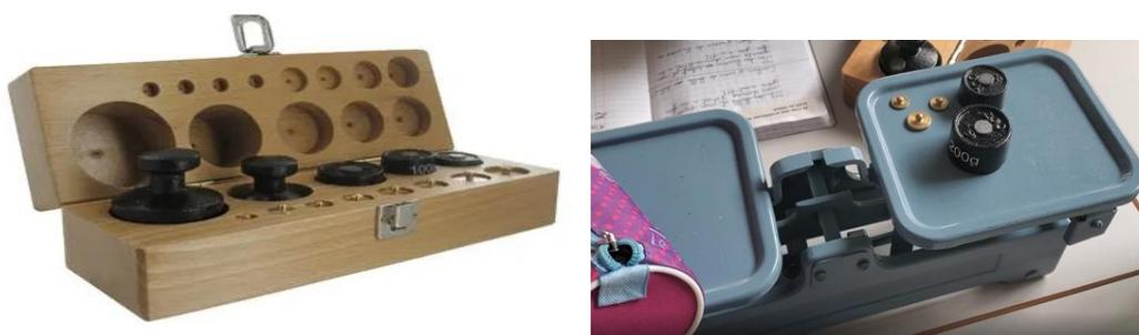
*Figure 7 : une balance Roberval et une boîte de masses marquées*
