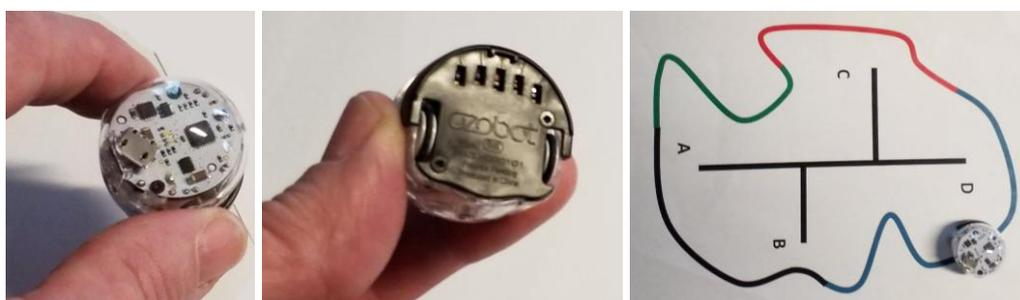
**Figure 1 :** ozobot : vues de dessus, de dessous puis sur un tracé
